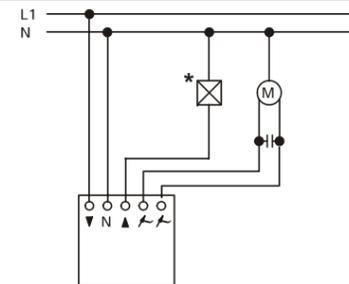
\* 230V für Zusatzfunktion (z.B. Verschlussklappe)
