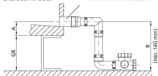
**Beispiel:** Unterdruck am Kondensatablaufanschluss  $P=1500 \text{ Pa}$  und Abstand A beträgt 70mm.
