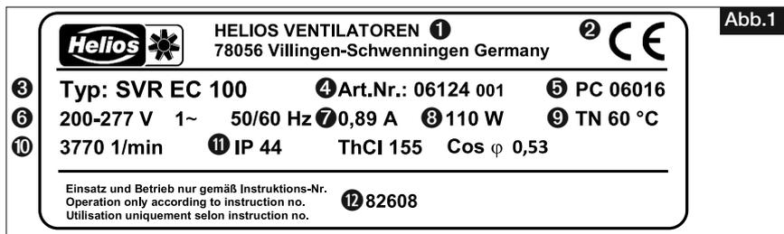
**Zeichenschlüssel Typenschild Ventilator:**
