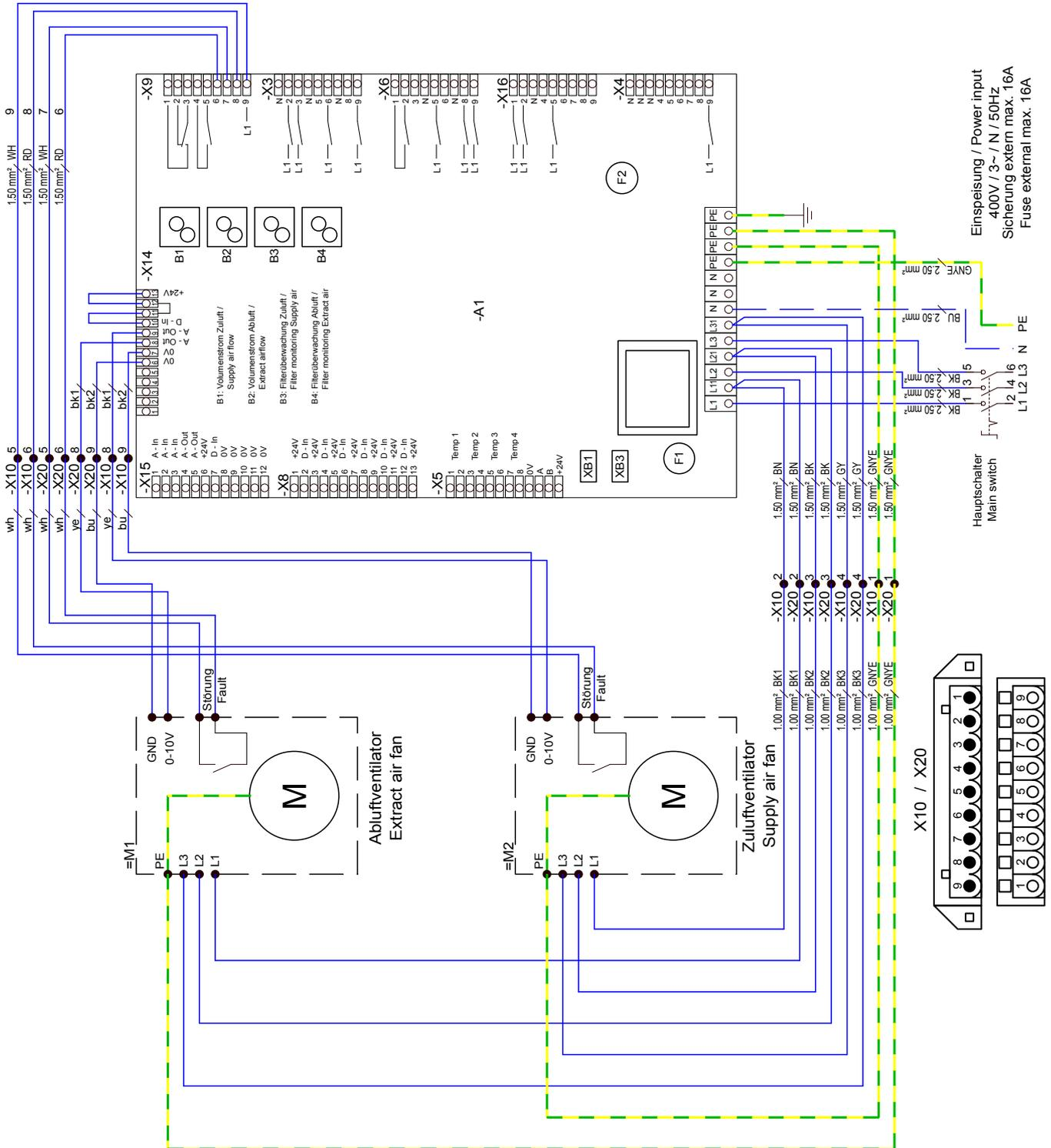
**ROTO K ... V**      Anschlußplan für Parameter P14 Externe Sensoren
