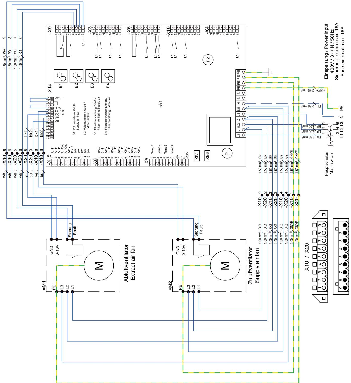
**ROTO K ... H** Anschlussplan Rotorantrieb
