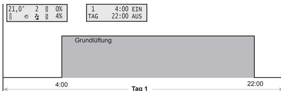
Abb. 13: Systemzeichnung bei Einstellung mit Zeitschaltuhr und Tag - Nacht Umschaltung
